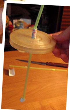
2. Расчерти на соломинке черточки. Вставь соломинку в картонную трубочку, а картонную трубочку в крышку. Прикрепи жвачку к нижней части соломинки.
